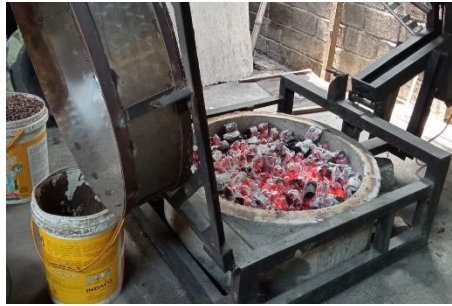
Gambar 1. 32 Mesin Sangrai I (Sumber : Dokumentasi Pribadi, 2021)
