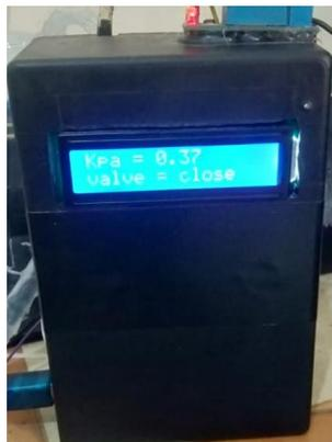
Gambar 4.tampilan LCD pada saat *Valve* tertutup
