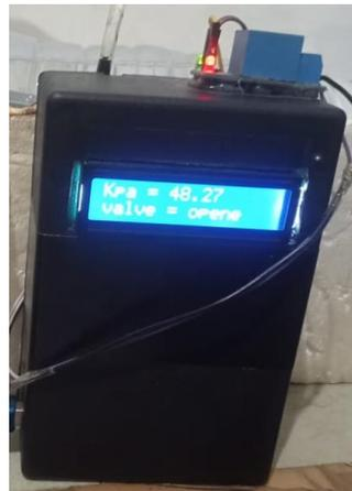
Gambar 5 tampilan LCD pada saat Valve terbuka
