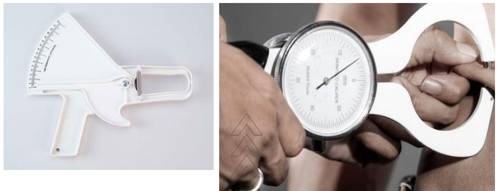
Gambar 4. Kiri: Skinfold caliper manual. Kanan: Skinfold caliper pegas
