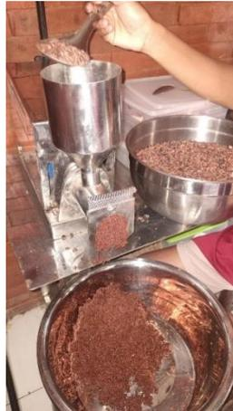
Gambar 1. 14. Penghalusan Menggunakan Mesin Pemasta
