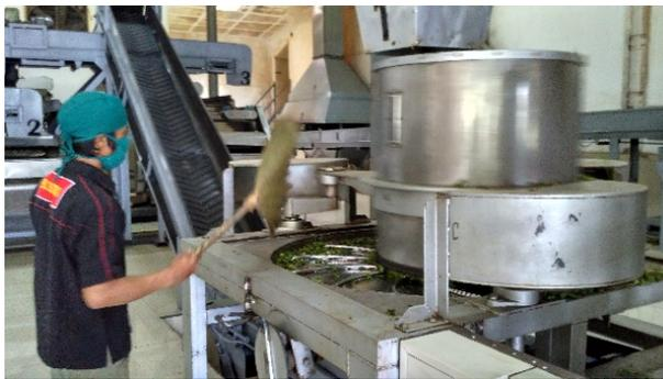
Gambar 1.7 Proses Penggulungan Menggunakan Mesin Penggulung
