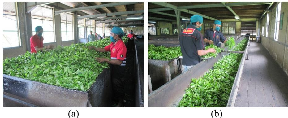
Gambar 1.5 (a) Pengiraban Pucuk Pada WT dan (b) Penurunan Pucuk Melalui *Conveyor*
