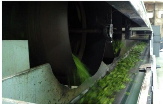
Gambar 1.6 Proses Pelayuan Pucuk dengan *Rotary Panner*
