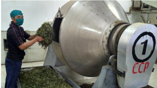
Gambar 1.9 Proses Pengeringan Akhir Menggunakan *Balltea*
