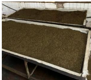
Gambar 1. 26 Alat Fermenting Trolies Sumber: Dokumentasi Pribadi
