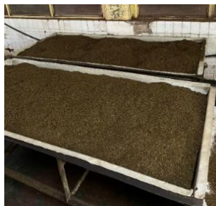
Gambar 1. 13 Proses Oksidasi Enzimatis Bubuk Teh Basah Sumber: Dokumentasi Pribadi
