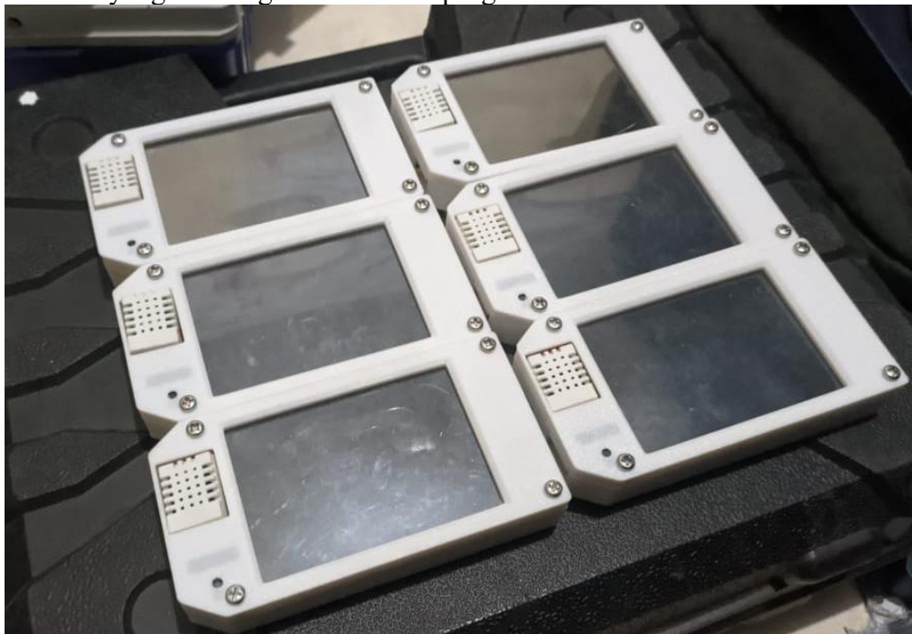
Gambar 3. Alat pemantau kondisi lingkungan belajar berbasis IoT
