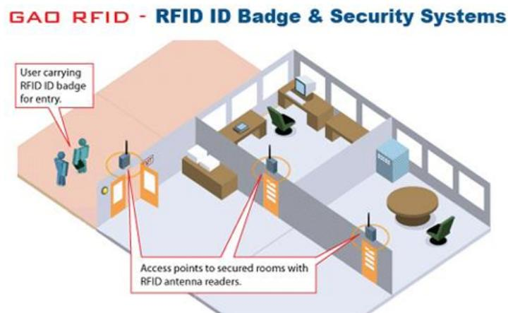
Gambar 1. Sistem Perangkat Akses Pintar RFID
