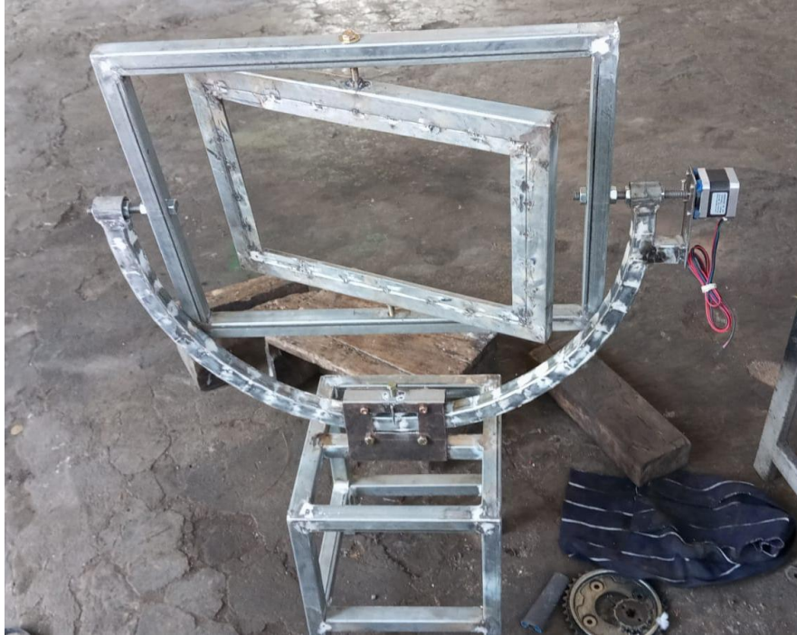
Gambar 8. Proses pembuatan solar tracker
